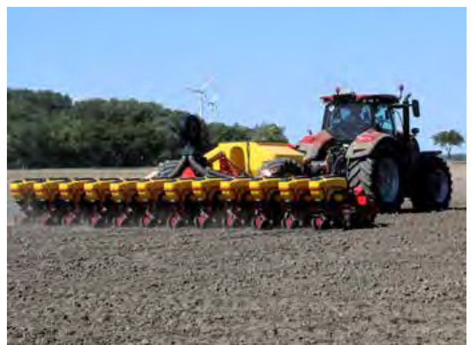
Mit Flüssigdüngersystem als weiterer Option: Die bewährte Einzelkornsämaschine Tempo L mit 8 bis 24 Reihen kann auch flüssigen Dünger exakt platzieren.
