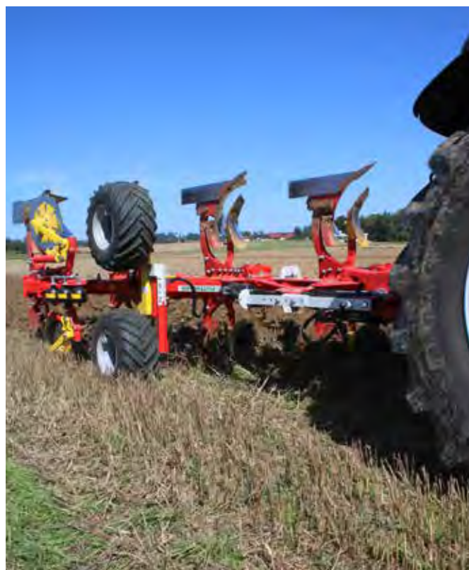
Neu ist am Servo 3000 die hydraulische Steinsicherung Nova. Der Hydraulikzylinder ist nun sicher zwischen zwei Pressschalen verbaut.
