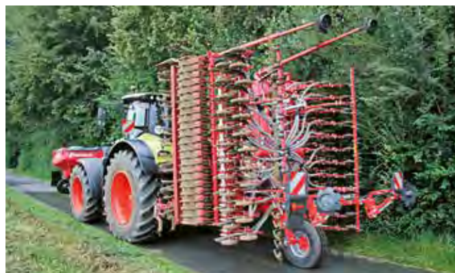
Das Zusatzstützrad am Heck der Kreiseleggen-Generation Rotago F. sorgt für einen sicheren und legalen Strassentransport (Axengewicht).
