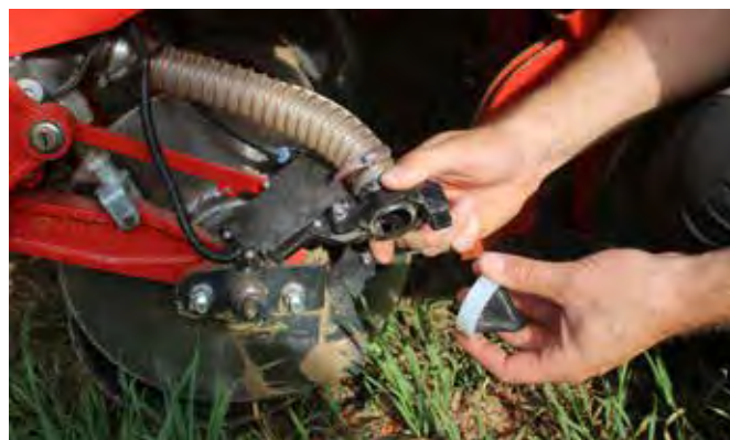
Säen und zugleich gezielt düngen: Der Dünger wird dabei pneumatisch als Düngedepot unter und neben dem Maissaatkorn präzise platziert.
