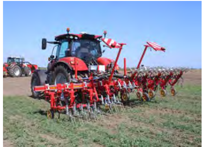
Einstieg in die Hacktechnik: Väderstad bietet u. a. die gezogene Variante Extract L in 6, 9 und 12 m Arbeitsbreite an.
