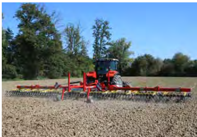
Einfache Einstellungsmöglichkeiten beim Striegel Tinecare V 12200. Den Druck der Doppelfedern von 500 bis 5000 kg ist zentral hydraulisch verstellbar.
