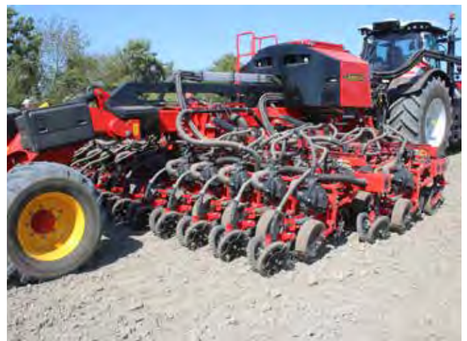
Universal-Einzelkorn-Sämaschinen: Neben Mais und Zuckerrüben soll diese Hightech-Maschine mit variierbarer Aussaatstärke bzw. teilflächenspezifischem Arbeiten auch für Getreide geeignet sein.
