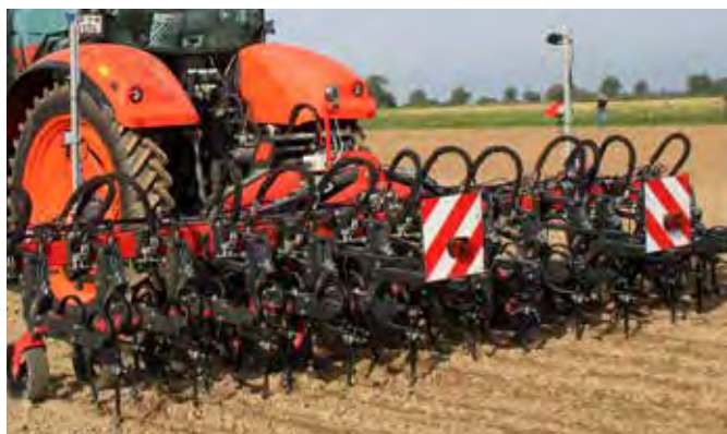
Hacken und spritzen: Kverneland bietet die Kombination aus kamerageführter Scharhacke Onyx mit dem System iXtra LiFe und Fronttank an.
