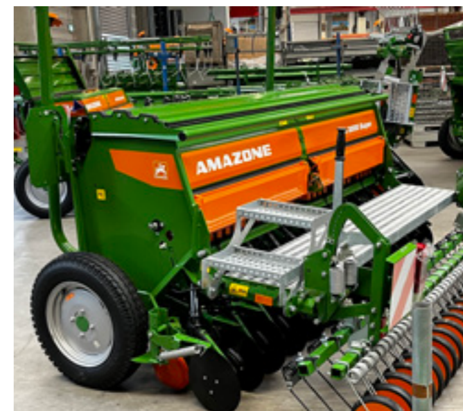
Y a-t-il quelqu'un qui ne la connaît pas ? Le semoir AD 3000 montée sur une herse avec une largeur de travail de 3 m.
