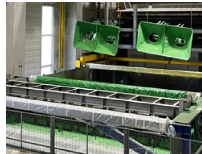
Les pièces sont immergées dans une peinture aqueuse électroconductive. Cela garantit un revêtement uniforme sans projections.
