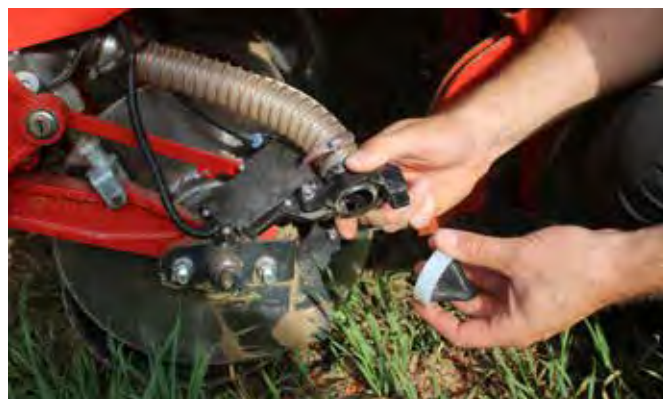
Semer tout en fertilisant de manière ciblée : L'engrais est alors placé pneumatiquement avec précision sous et à côté de la graine de maïs en tant que dépôt d'engrais. En détail, le système de dosage équipé de poils en plastique.
