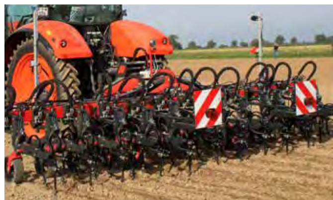
Biner et pulvériser en même temps : Kverneland propose la combinaison de la bineuse à socs guidée par caméra Onyx avec le système iXtra LiFe et la trémie frontale comme solution technique.
