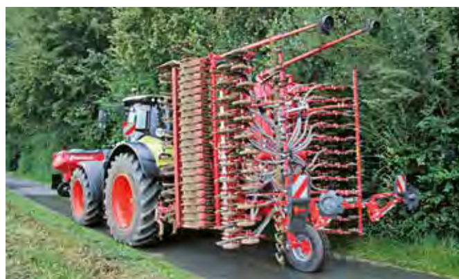
Contrôler la profondeur de travail de manière automatisée depuis le tracteur : C'est ce que permet la nouvelle génération de herbes rotatives Rotago F. Une roue d'appui supplémentaire à l'arrière de la combinaison d'outils assure un transport sur route sûr et légal (poids par essieu).
