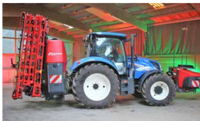
TwinFil : il s'agit du programme de remplissage automatique pour les pulvérisateurs portés avant et arrière.
