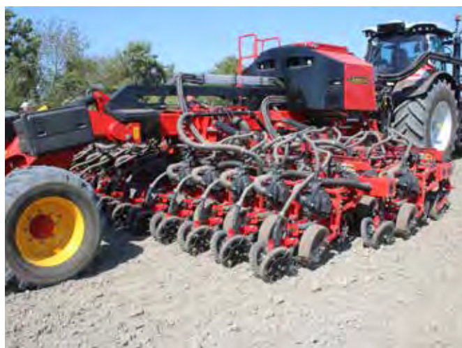
Semoirs monograinnes universels : Cette machine high-tech, qui permet de varier la densité de semis ou de travailler spécifiquement sur une partie de la surface, doit également être adaptée aux céréales, en plus du maïs et des betteraves sucrières.
