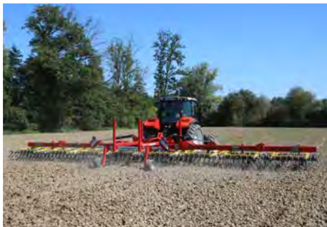
Le Tinecare de Pöttinger : Possibilités de réglage simples sur la herse Tinecare V 12200. La pression des doubles ressorts peut être facilement réglée ou adaptée de manière centrale et hydraulique de 500 à 5000 kg.
