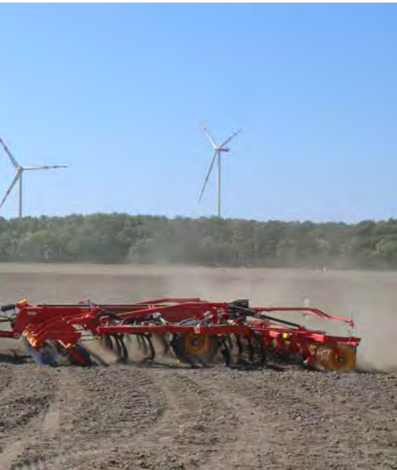
Introduction à la technique de binage : Väderstad propose entre autres la variante traînée Extract L en 6, 9 et 12 m de largeur de travail.
