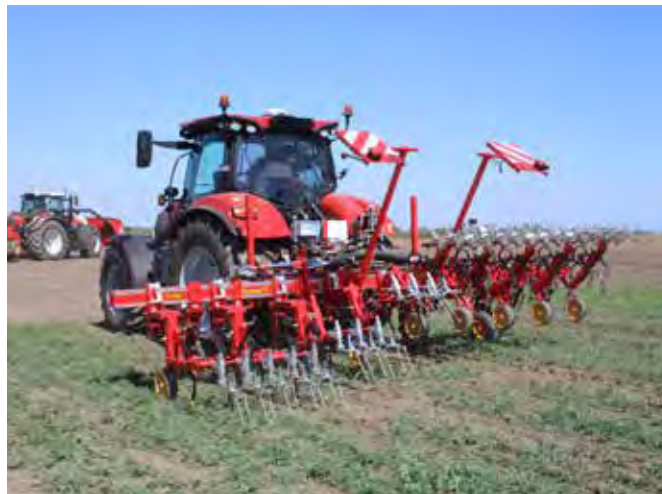
Introduction à la technique de binage : Väderstad propose entre autres la variante traînée Extract L en 6, 9 et 12 m de largeur de travail.
