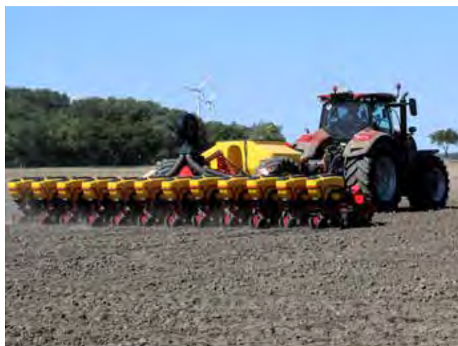
En option, un système d'engrais liquide : Le Tempo L, semoir monograinne équipé de 8 à 24 rangs, peut également placer avec précision l'engrais liquide.
